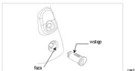
Można zamka zabezpieczającego w korpusie uchwytu. Będzie on zamka i trzeba tak na kierować aby jego występ trafi bezpośrednio w fazę otworu. Wcisnąć ją mocno zamek w korpus usłyszmy kliknięcie informujące o prawidłowym położeniu
